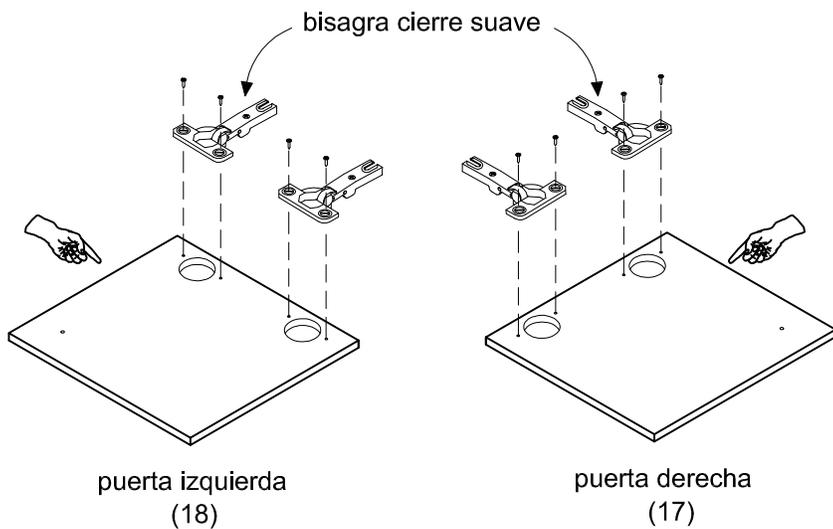
**PRECAUCION:** Existen 2 tipos de bisagras, recta normal y recta cierre-suave. Para diferenciarlas, proceda a cerrar cada una...las que se junten lentamente son bisagras cierre suave. Estas deben instalarse en la perforación superior de ambas puertas (la que está hacia el canto superior enchapado).
